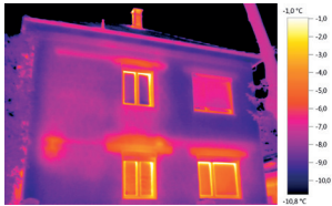
Immagine termografica con ScaleAssist
